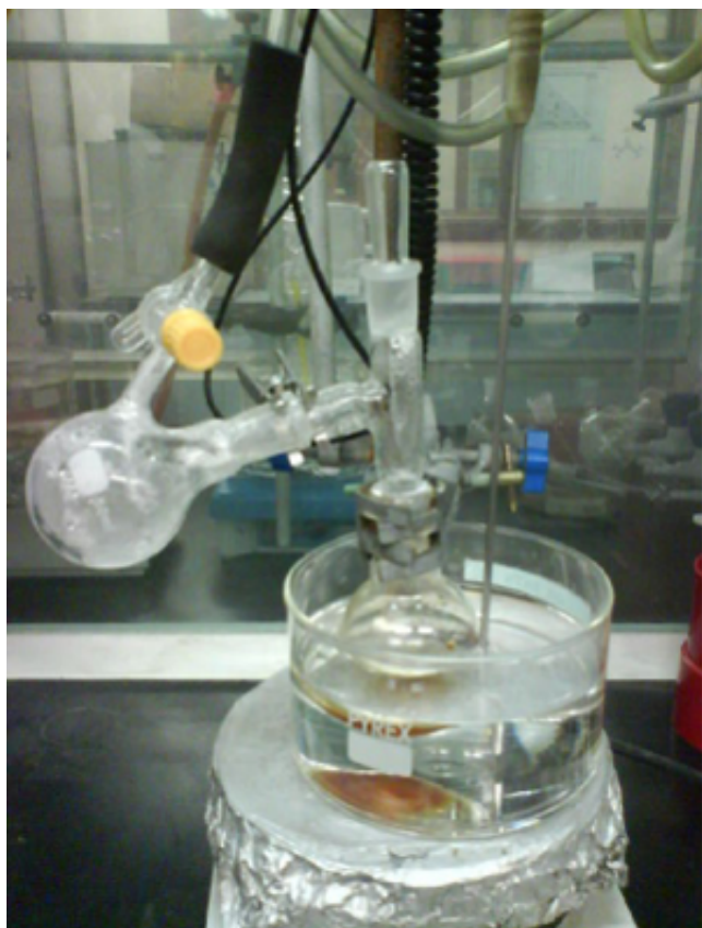
Le DMSO en cours de distillation.
