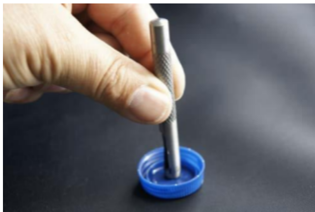
Fig. 51 : Exemple de méthode pour percer des trous dans les bouchons de bouteilles.
